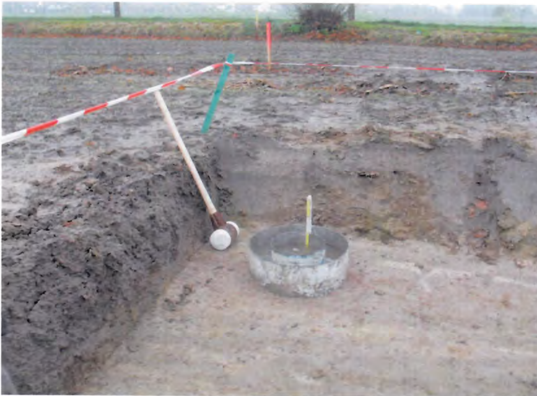
Bild 3: Anordnung Versickerungsversuch V1
